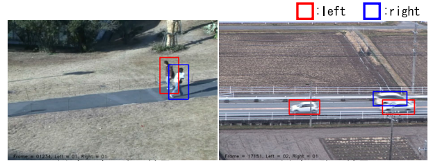
図 4: 移動物体の方向識別とセグメンテーション例
